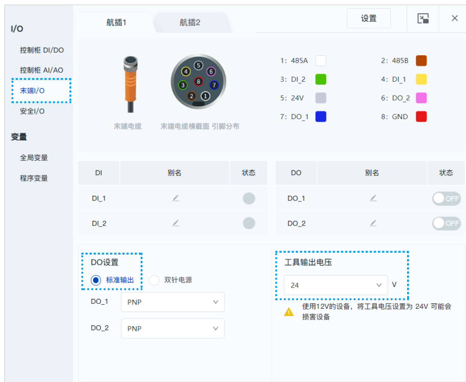
图 5.27 末端 I/O (M8) 配置-单针模式
